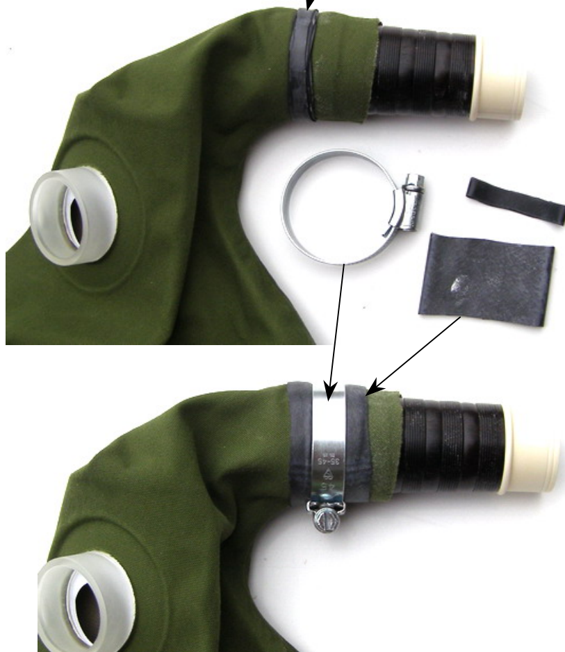
Montage mit Schlauchstücken und Schelle
